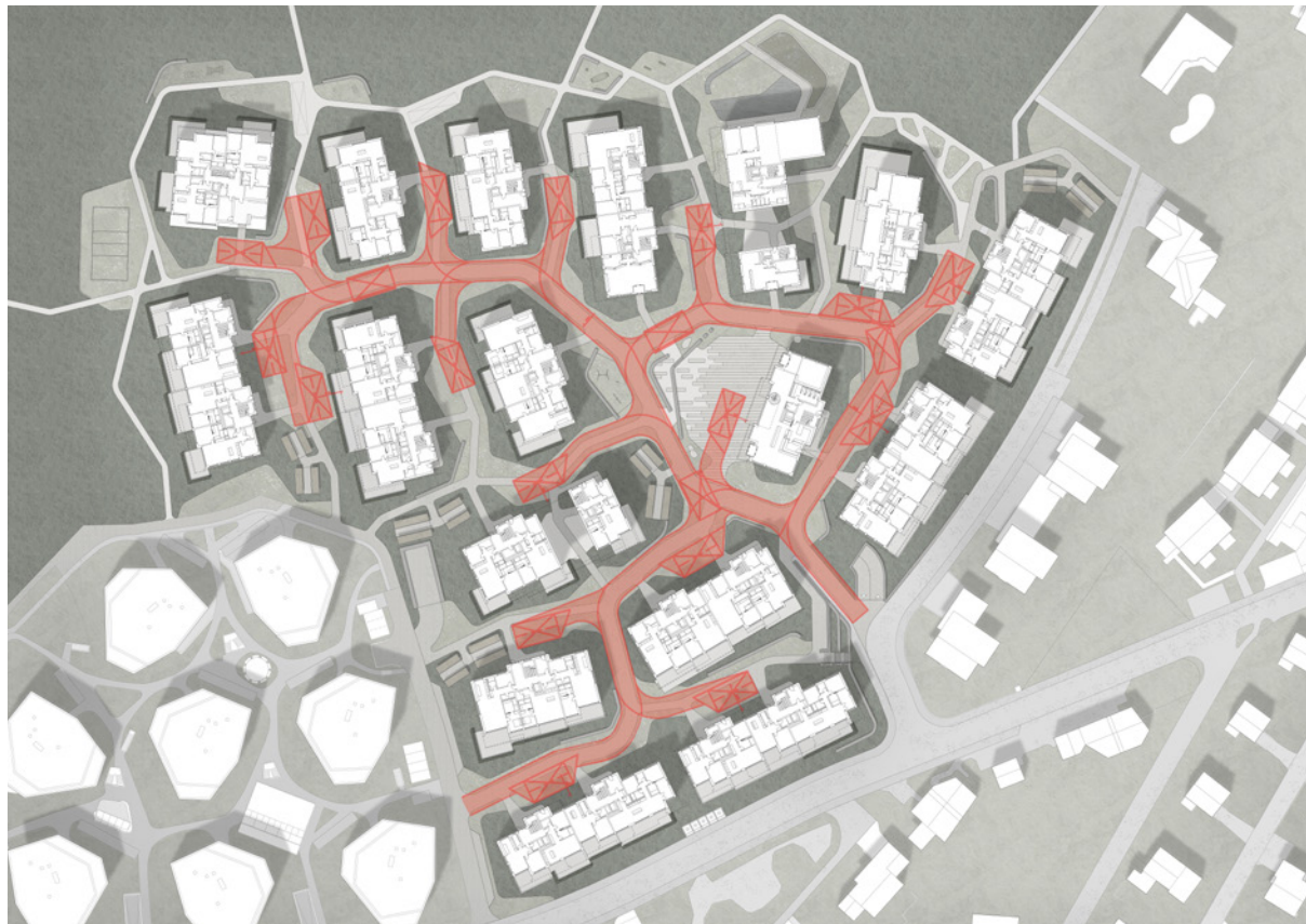
Der zentrale Route hat eine Breite von 3,5 Metern und ist auch für die Feuerwehr geeignet.
