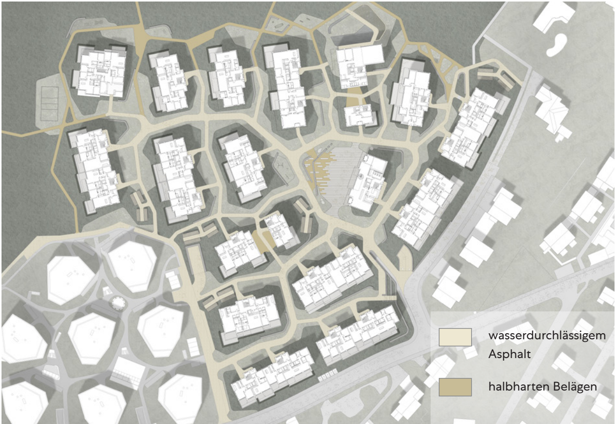
Die Wegebefestigung besteht überwiegend aus wasserdurchlässigem Asphalt und halbhartem Belägen die sich wunderbar in die Umgebung einfügen.
